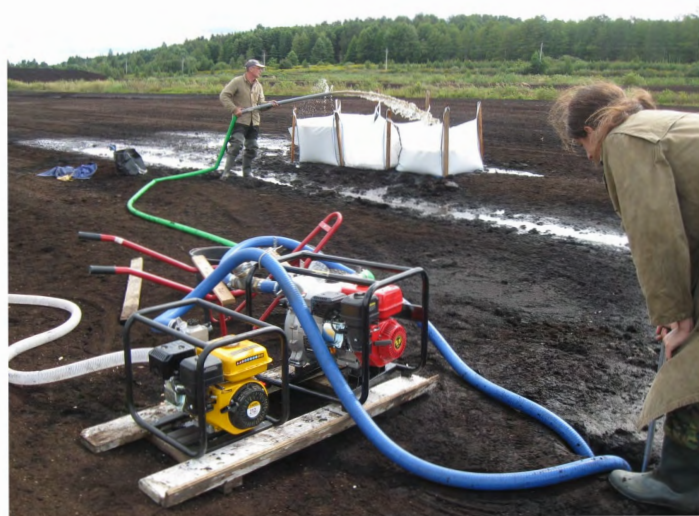
Рис. 2. Оборудование и изделия для добычи сапропеля из-под торфа на опытном участке
