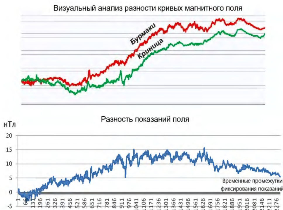
Рис. 2. Абсолютная разность показаний поля Z между зоной аномальных магнитных возмущений и зоной отсутствия аномального магнитовозмущающего тела
