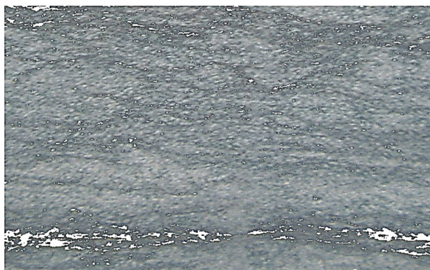
Рис. 2. Фотография участка образца породы рытской свиты (глина алевролитистая, глубина 1234,6 м, скважина 71) с наличием порового пространства (белые участки)
