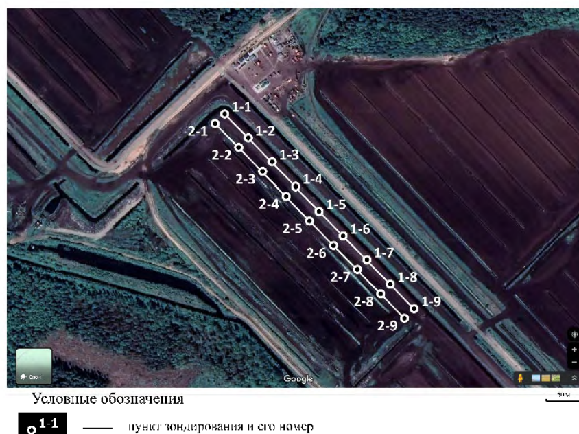
Рис. 1. Схема расположения пунктов зондирования для определения мощности торфа и сапропеля на опытном участке
